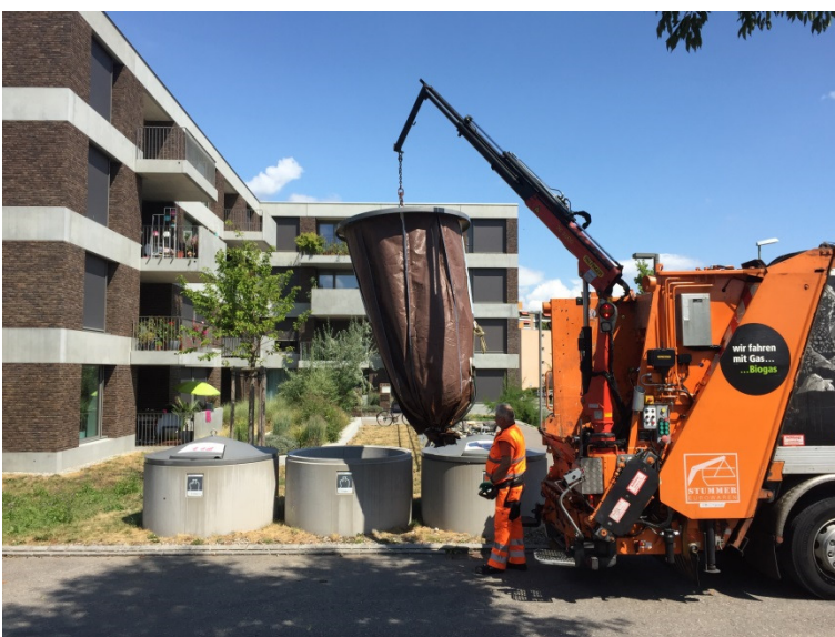
oben: UFC-Sammelpunkte Altstadt unten: Der Hebesack wird mit einem Heckkran aus dem Untergrund gehoben und anschliessend ins Kehrichtfahrzeug entleert.
